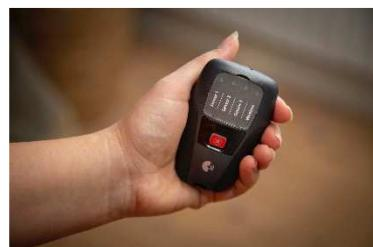
Die Funktion des Sensors wird durch regelmäßige Selbsttests geprüft. Im Falle eines Stromausfalls wird mit Hilfe einer internen Stützbatterie ein Alarm gesendet.
